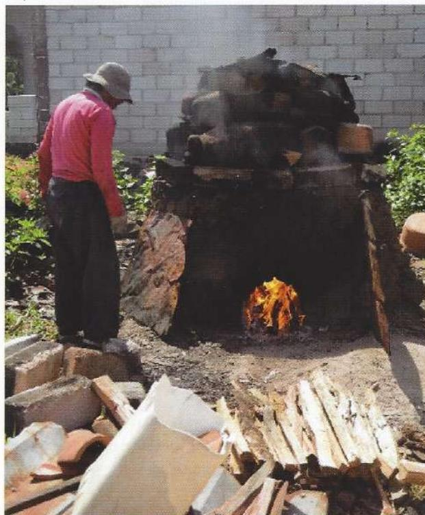
Imagen No.2: Horno para cocción de utensilios de barro. Fotografía de Leonardo Vega Flores. Tlayacapan, Morelos, 26 de mayo 2018.
